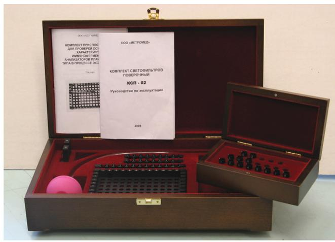
Рис. 7 Комплект для поверки и контроля иммуноферментных и биохимических анализаторов
