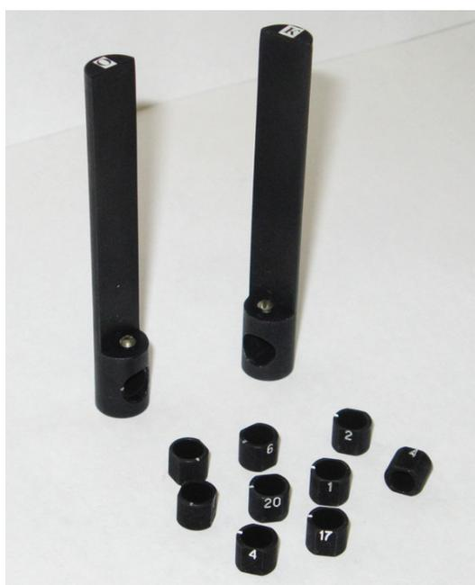
Рис. 4 Установочные элементы для биохимических анализаторов с цилиндрической кюветой
